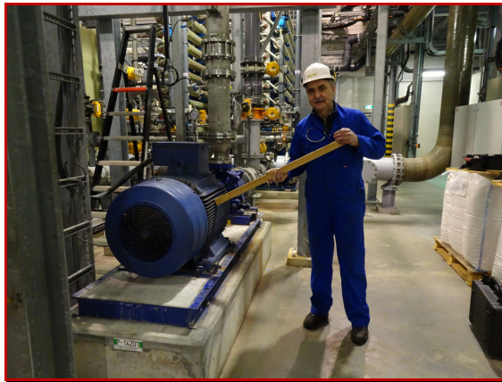
Fig. 2.5: Het motor frame in trilling brengen met een bump test.
