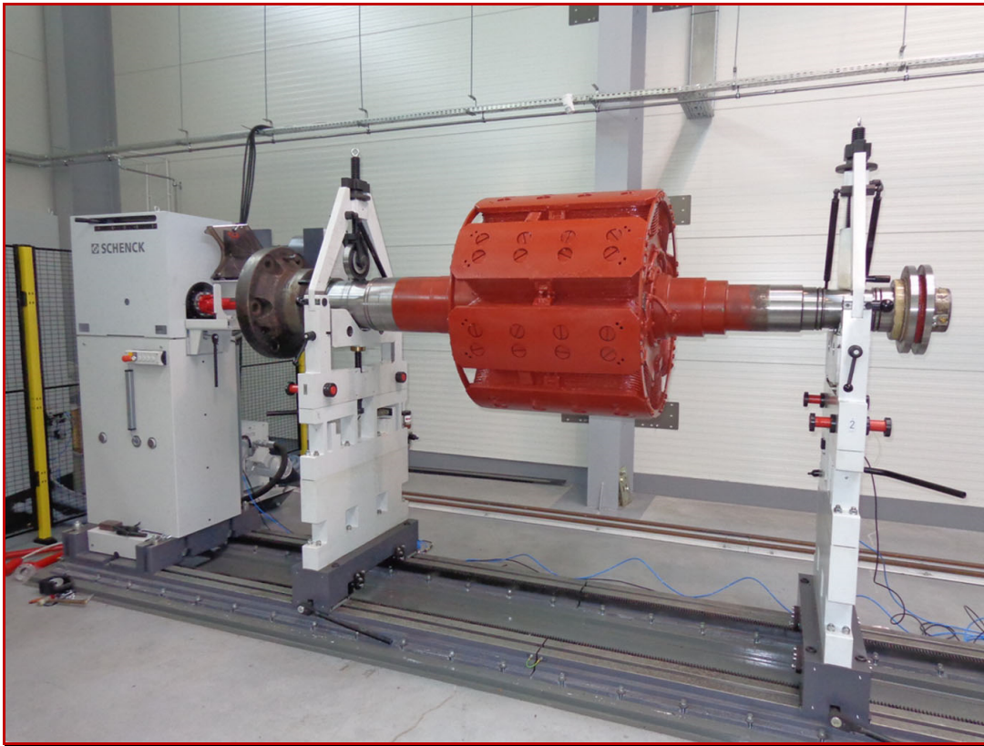
Fig. 12.9: Rotor van een synchrone generator in een balanceerbank van Carl Schenck, www.schenck-rotec.net
