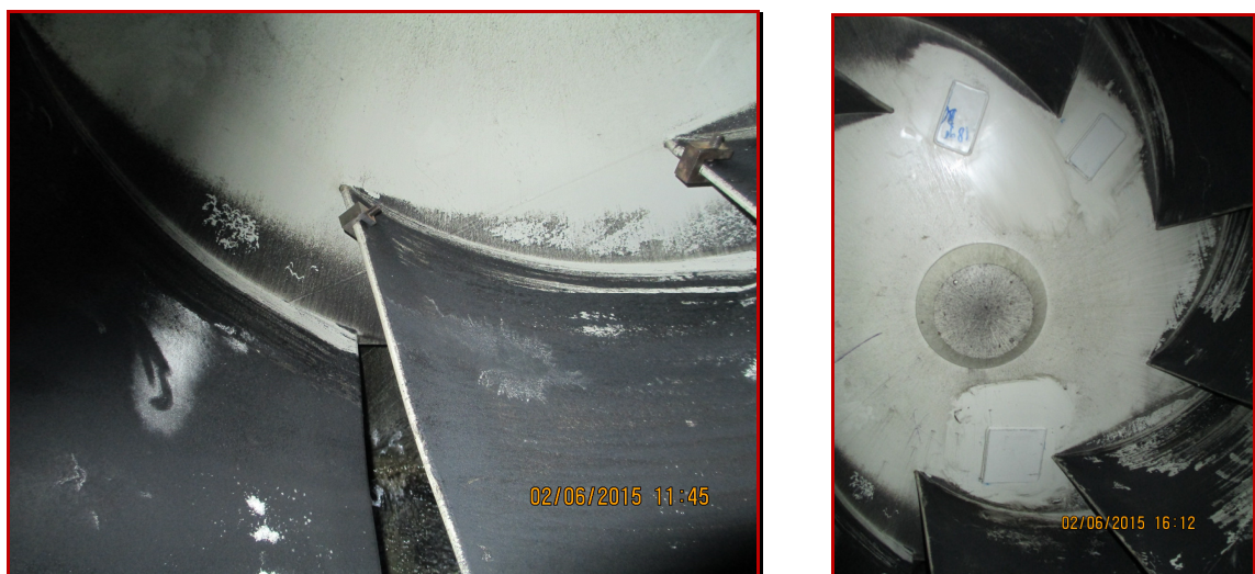
Fig. 12.3: Correctie gewichten op ventilator waaier van kunststof, gezien vanaf inlaatzijde.
