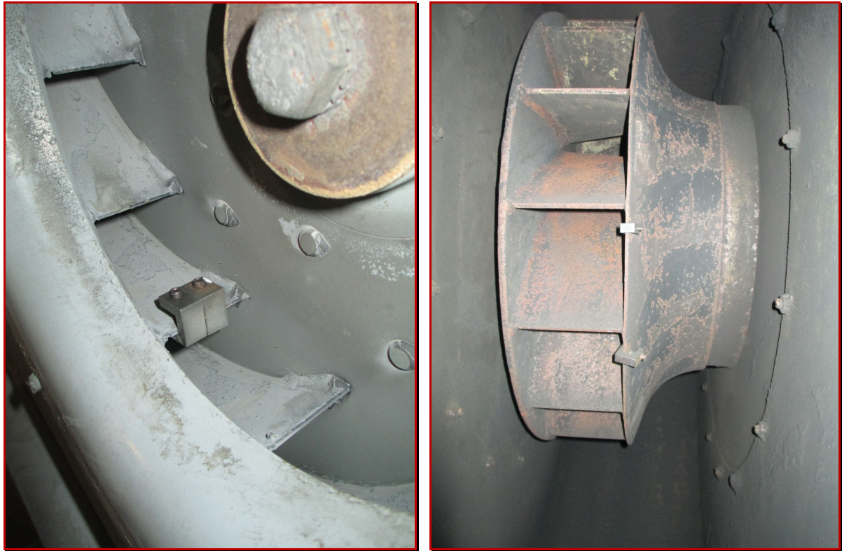
Fig. 12.2: Correctie gewichten op ventilator binnen- (links) en buitendiameter (rechts).
