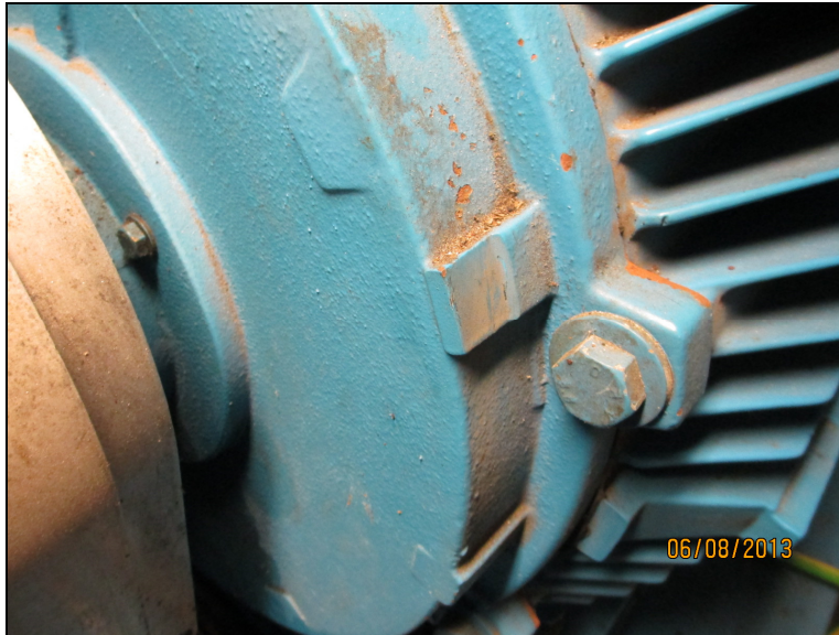
Fig. 6.9:: Voor een magneet geschikt vlak meetoppervlak op schild motor.
