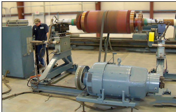
Fig. 12.7: Twee-vlaks balanceren elektromotor rotor op de balanceerbank. Aan beide rotor zijden zijn balanceerschijven voorzien (nooit de kortsluitringen gebruiken!).
